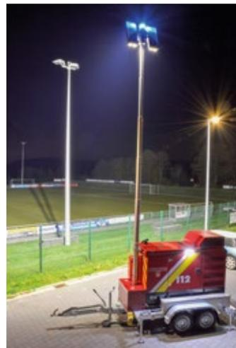
**Das neue, mobile Stromaggregat mit einer Leistung von 66 kVA. Der Generator ist mit einem neun Meter hohen und 200.000 Lumen starken Lichtmast ausgestattet. Mit dieser Neuanschaffung können Einsatzstellen großflächig ausgeleuchtet werden oder Notstrom direkt in das Hausnetz des Feuerwehrhauses eingespeist werden.**
